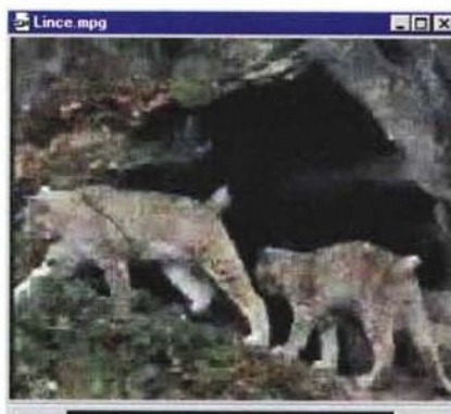
Figura 10 - Lo stesso file visto a grandezza doppia. La grana diventa subito consistente ed appare un disturbo video: l'acquisizione non è delle migliori. Così come consiglia il manuale, per Creative MPEG Encoder è meglio acquisire i file in modalità full-frame. Senza cioè effetti "flossy" impressi dalle fasi di compressione intermedie.
